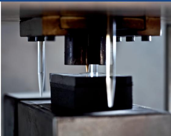
• **Prova di compressibilità** con cui si valuta la deformazione del materiale frenante sottoposto ad una pressione specifica predeterminata. Il valore rilevato non deve essere superiore al 2% dello spessore iniziale per le prove a temperatura ambiente, mentre non deve essere superiore al 5% dello spessore iniziale per le prove effettuate a 400°C.
